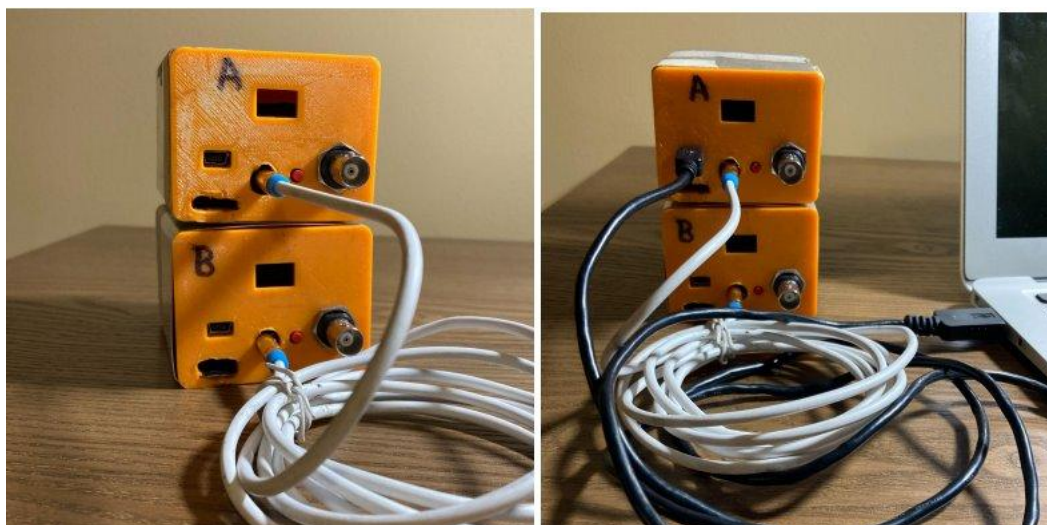
Figura 6. Configuración y disposición de los detectores en modo coincidencia previos a su uso
